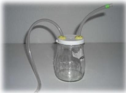
1. Percer deux trous dans le couvercle du pot avec l'aide d'un adulte. Les trous doivent être assez large l'un pour faire la paille et l'autre pour faire passer le tuyau.
